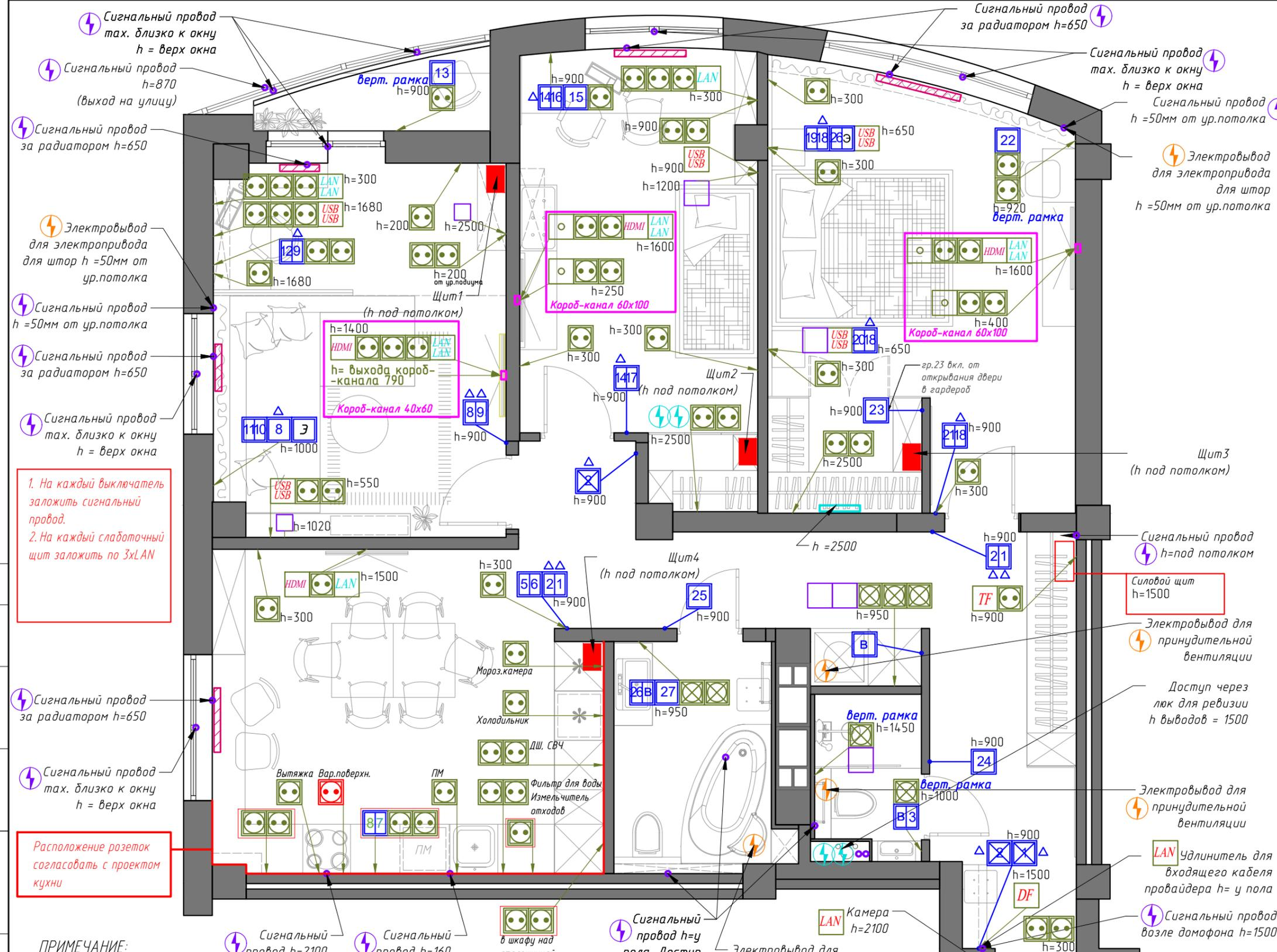
1. На каждый выключатель заложить сигнальный провод.
